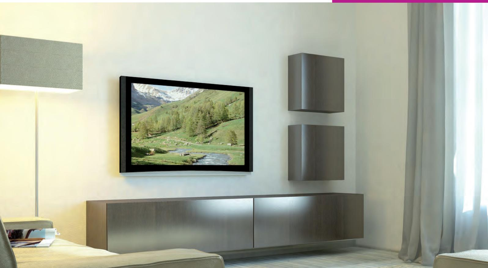
Knauf Kasa può supportare carichi di vario genere in qualsiasi punto. Per sostenere carichi importanti (come televisori o pensili) è consigliabile accoppiarla con una Lastra Diamanti® o Vidiwall®. Il fissaggio del carico deve essere fatto con minimo due tasselli da cartongesso (a norma DIN 18183) in plastica o in metallo.
