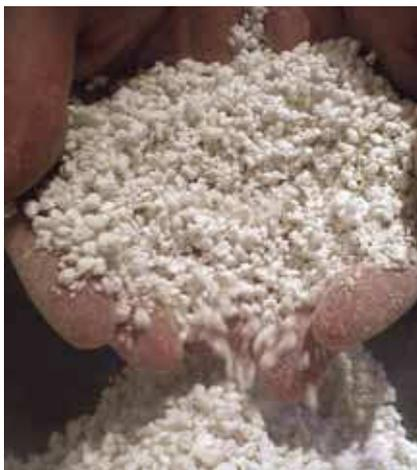
InterPARETE è un isolante a base di roccia vulcanica silicatica perlite, che ha la capacità di espandere il proprio volume fino a 20 volte rispetto a quello originale. L'espansione avviene a temperature comprese tra 850 e 1000° C ed è legata alla presenza di acqua rimasta chiusa nella roccia. La roccia si espande per la vaporizzazione dell'acqua: in questo processo si generano delle cavità all'interno dei granuli che le conferiscono ottime proprietà termo-isolanti e un'eccezionale leggerezza.
